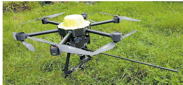
Durch den langen geraden Rüssel der Borkenkäfer-Drohne wird die Luft angesaugt und zu einem elektronischen Sensor geleitet. Der prüft, ob und in welcher Konzentration in dem Gasgemisch bestimmte Monoterpene enthalten sind, die im Fichtenharz vorkommen. Vom Borkenkäfer befallene Fichten sondern viel Harz ab. Bild: Sebastian Paczkowski
